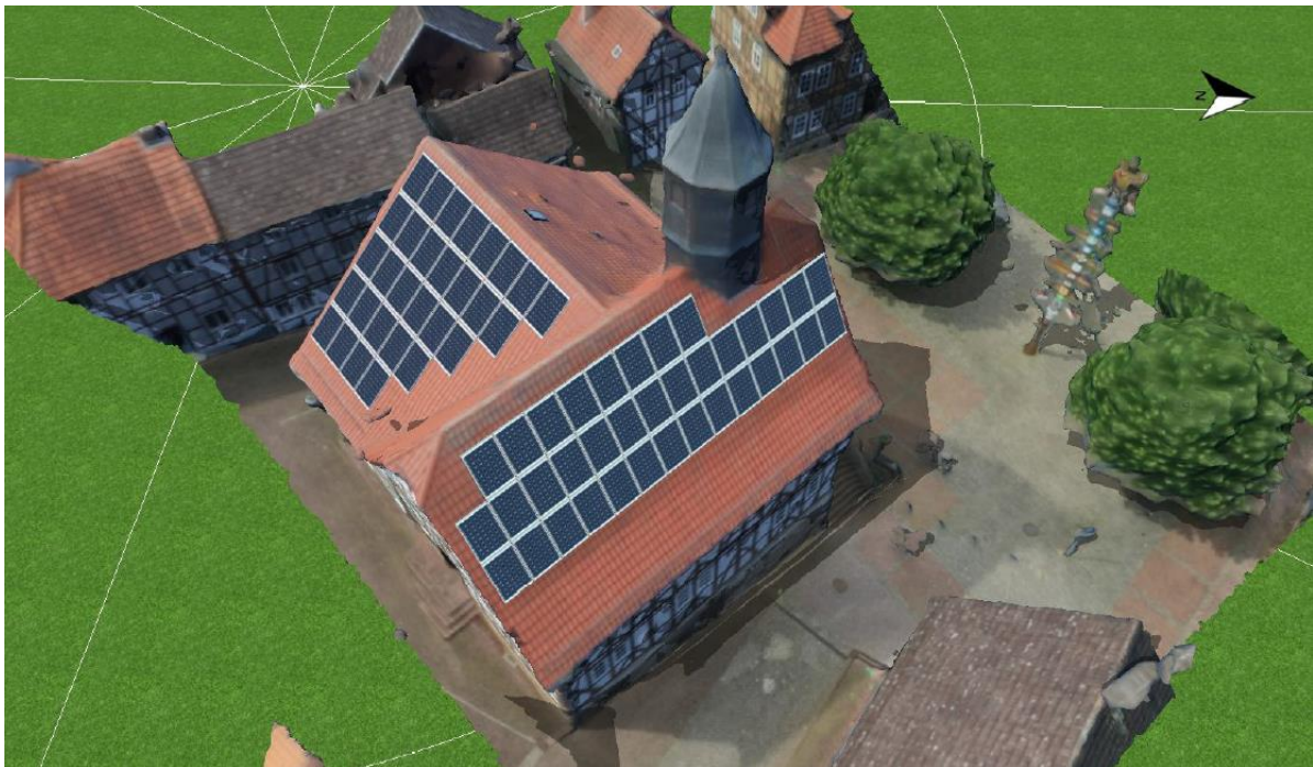
Abbildung 16: PV-Dachbelegung Rathaus 1 (Übersichtsbild 3D-Planung)
