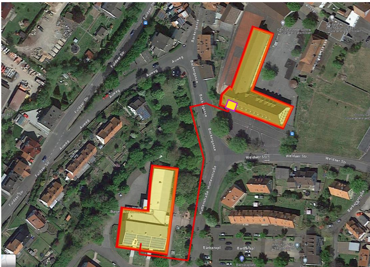
Abbildung 24: Nahwärmeleitung von der Regenbogenschule zum Bürgerhaus
